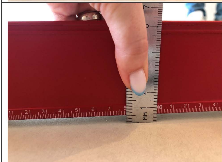
Фото №11. Измерение напольного покрытия коридора в квартире.
